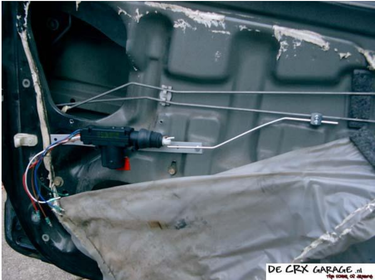
De schakelstang aangebracht.
