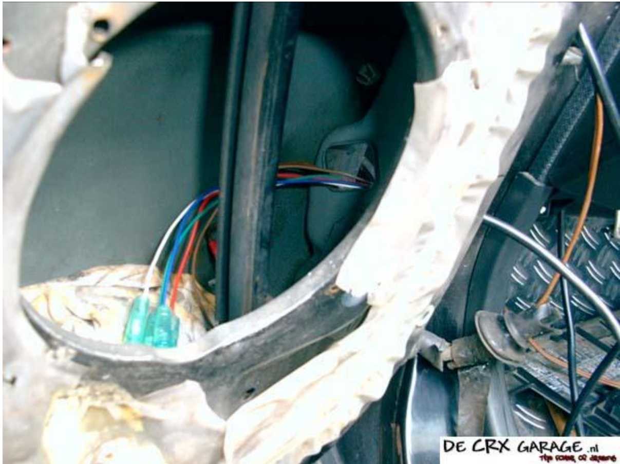
Het doorvoergat in de deur.
